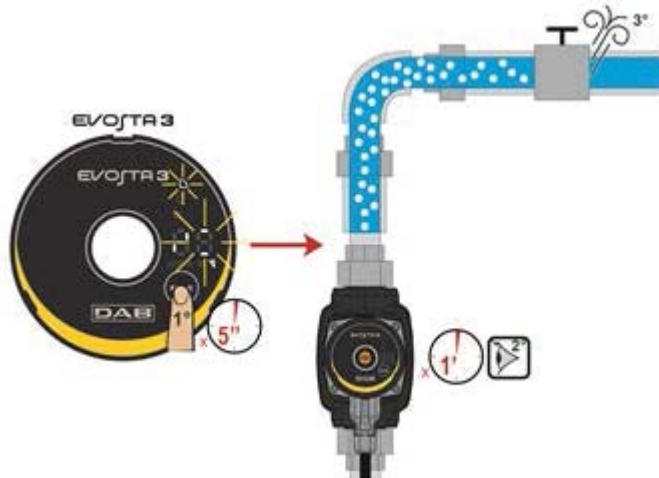
Obrázek 9: Automatické odvzdušnění čerpadla
